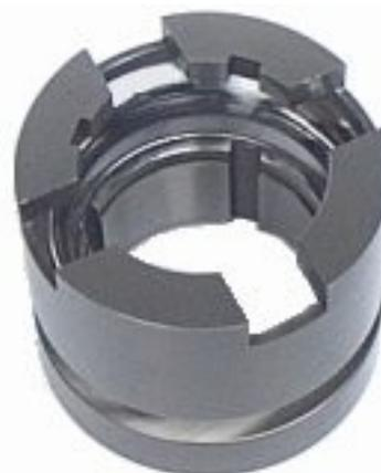
Ces bobinots offrent deux positions de montage des chiens de serrage permettant de les utiliser deux fois. Leur dureté est supérieure à 60 HRC. Ils sont rectifiés et polis sur leur surface de travail.
