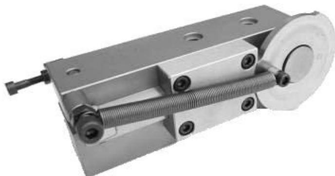
Le fonctionnement est le suivant : le chariot transversal, sur lequel est installé l'appareil, avance jusqu'à ce que le disque entre en contact avec la barre en rotation. Ce dernier se trouve alors entraîné et reporte l'inscription sur la pièce.
