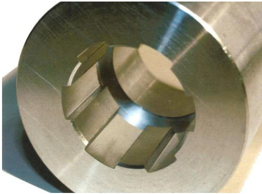
Cannelures cylindriques - Côtés parallèles Centrage interne - Lamage de finition Réalisé sur tour CN
