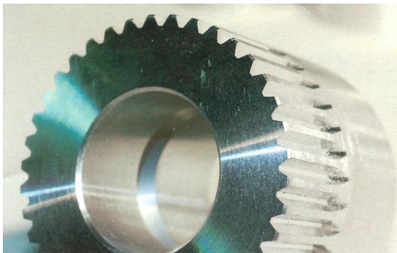
Denture externe cylindriques à profil développant Pas de lamage de finition Réalisé sur tour CN
