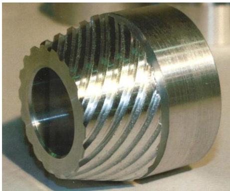
Profil rainuré externe trapézoïdal et spiroïdal Lamage de finition Réalisé sur tour CN
